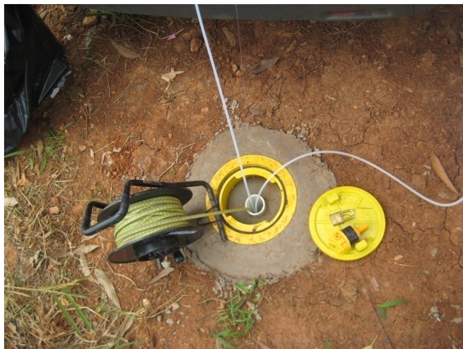
Figura 39 – Procedimento de coleta com acompanhamento e medição de parâmetros de campo.
