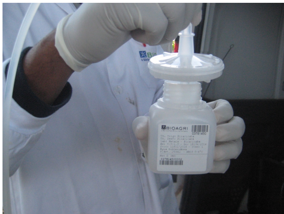
Figura 38 – Realização da filtragem em campo da amostras de água subterrânea.
