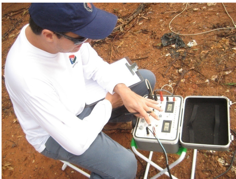
Figura 18 – Eletrorresistivímetro utilizado para o caminhamento elétrico.
