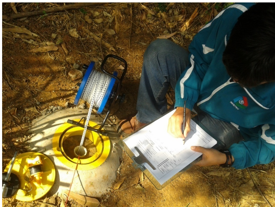
Figura 42 – Execução do Slug Test no poço PM-08.
