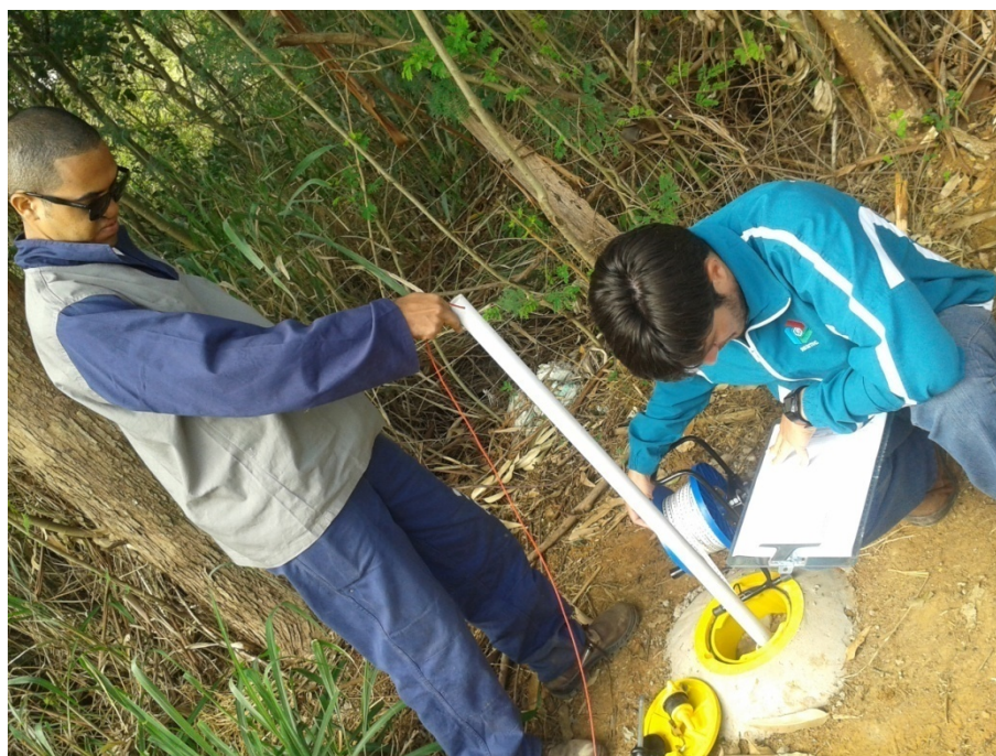
Figura 41 – Início do ensaio de permeabilidade (slug test) no poço de monitoramento.
