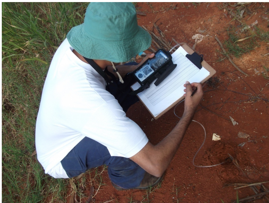
Figura 36 – Medição em campo dos parâmetros Metano, Oxigênio e PID, com o aparelho IBRID modelo Mx6.
