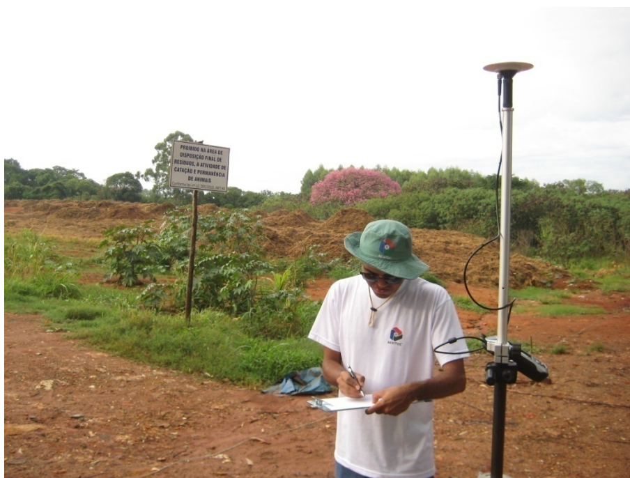
Figura 21 – Utilização do GPS Geodésico para realização do levantamento planialtimétrico cadastral.
