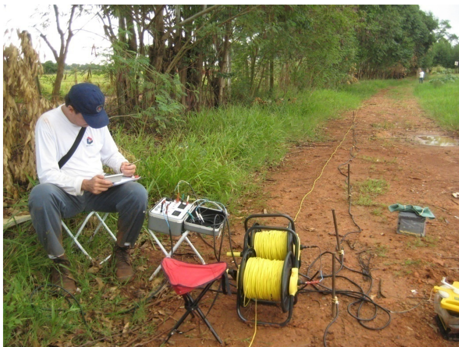
Figura 19 – Execução do método de sondagem elétrica vertical – SEV na área de estudo do vazadouro de resíduos.
