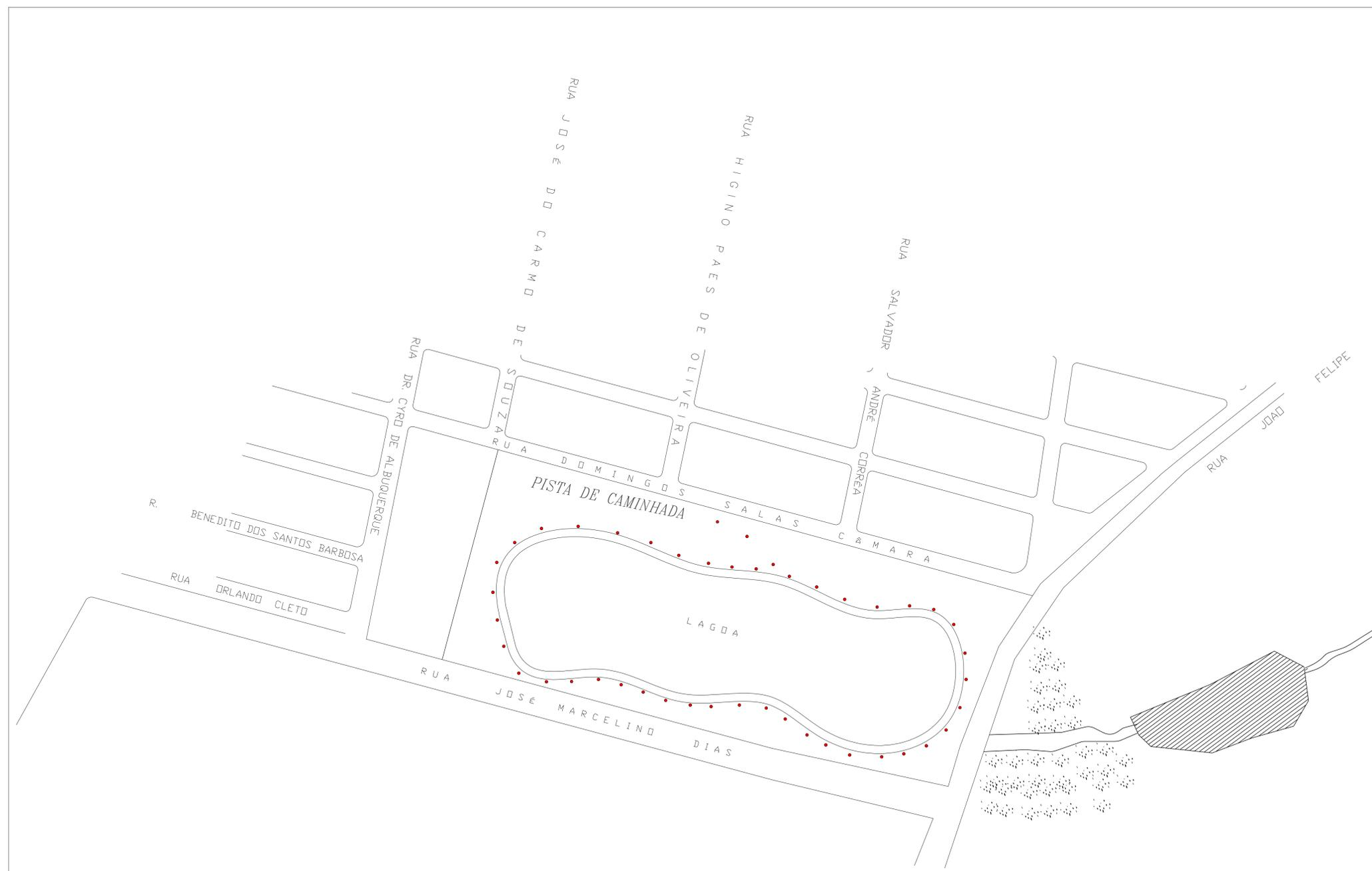
● 45 POSTES 9 METROS COM REDE SECUNDÁRIA MULTIPLEXADA E CONJUNTOS DE ILUMINAÇÃO COM BRAÇOS TIPO CURTO, LUMINÁRIA ABERTA, LÂMPADAS 150W VAPOR DE SÓDIO, BASE, RELE E REATOR (CS15).
