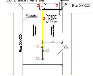
Detalhe "5": Pintura de redutor de velocidade
