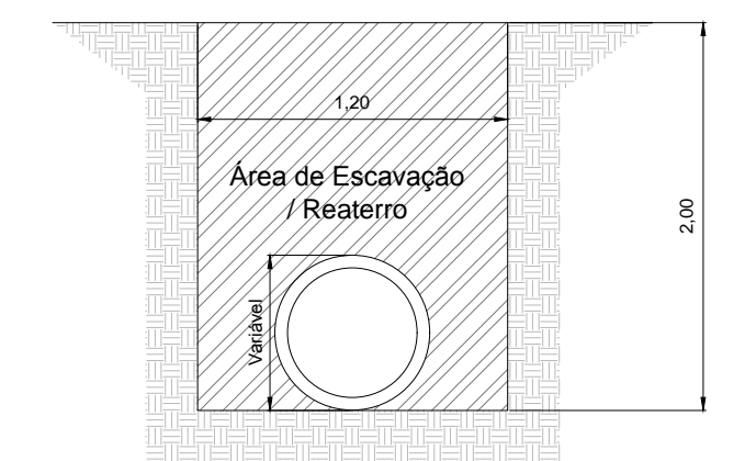
DETALHE DE ESCAVAÇÃO DE VALA S/ESCALA
