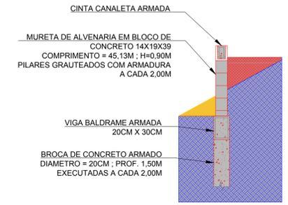
DETALHE CONSTRUTIVO DE FUNDAÇÃO E MURETA PARA MURO DE CONTENÇÃO DO ESTACIONAMENTO
