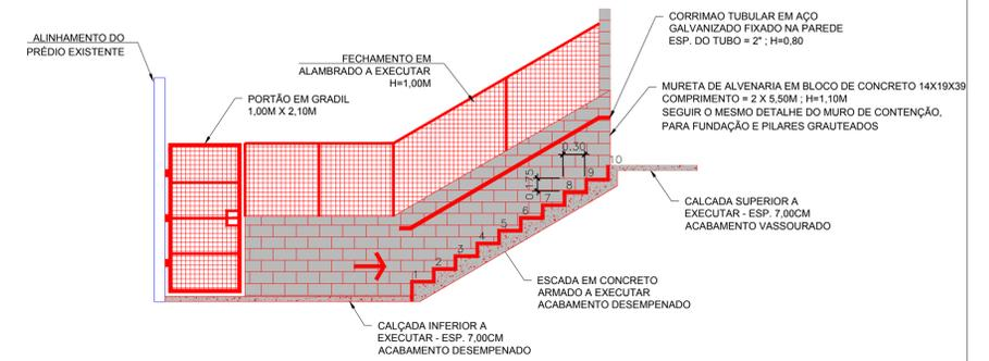
CORTE A-A DETALHE PARA CONSTRUÇÃO ESCADA DE ACESSO E FECHAMENTO
