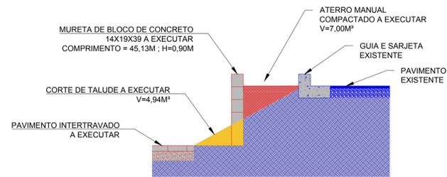
DETALHE PARA DE CORTE E ATERRO PARA MURO DE CONTENÇÃO DO ESTACIONAMENTO
