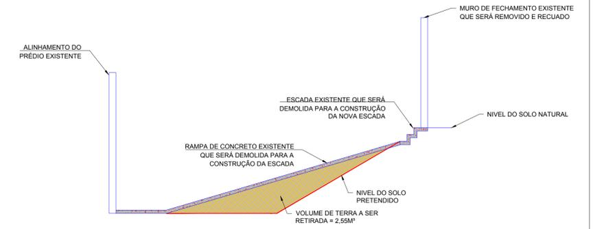
DETALHE DE CORTE DE TERRA E DEMOLIÇÃO PARA ESCADA DE ACESSO
