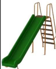
Fabricado com tubos de aço carbono de no mínimo 2" x 2 mm; 1" x 1,5 mm; chapas de aço carbono de no mínimo 3 mm; degraus em madeira plástica e escorregador de plástico rotomoldado de 2,60 m. Pintura a pó eletrostática poliéster, solda mig. Instalação em áreas fechadas ou ao ar livre, resistente às ações climáticas.
