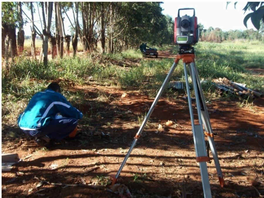
Figura 22 – Utilização de Estação Total para nivelamento topográfico.
