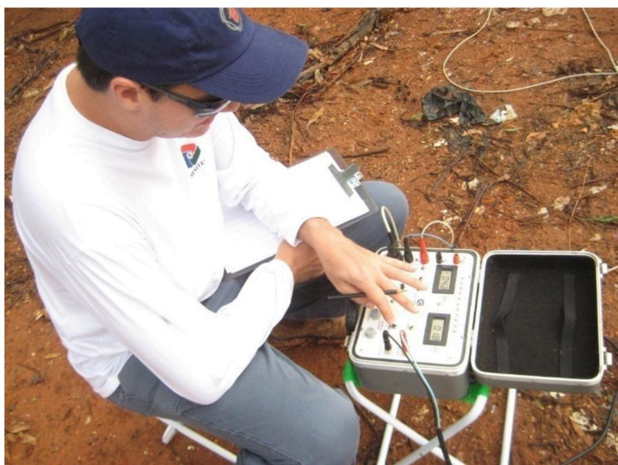
Figura 18 – Eletrorresistivímetro utilizado para o caminhamento elétrico.
